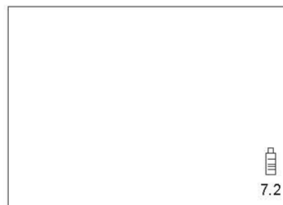
Σχήμα 2.3. Ένδειξη κατά την φόρτιση της μπαταρίας όταν το όργανο είναι κλειστό
