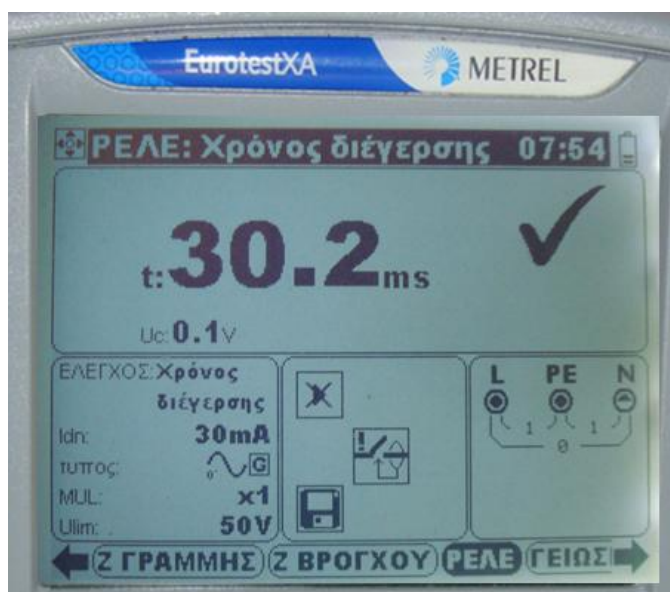
Σχήμα 5.28. Παράδειγμα μέτρησης Χρόνου Διέγερσης
