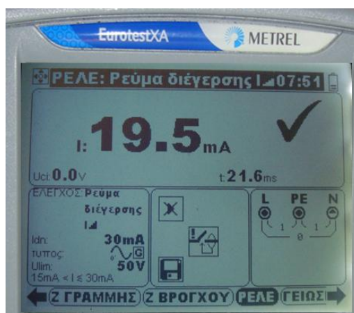
Σχήμα 5.29. Παράδειγμα ελέγχου Ρεύματος διέγερσης I
