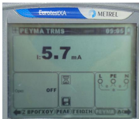
Σχήμα 5.43. Παράδειγμα μέτρησης ρεύματος
