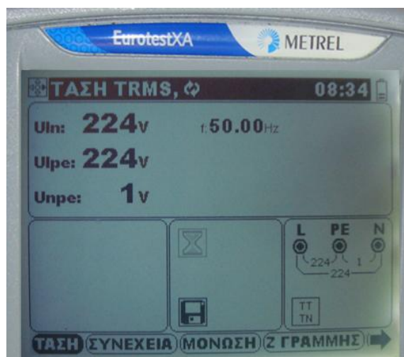
Σχήμα 5.1. Μέτρηση τάσης σε μονοφασικό
