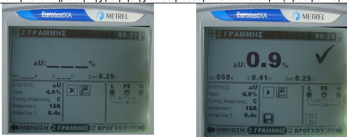
Σχήμα 5.21. Τα δύο βήματα μέτρησης πτώσης τάσης
