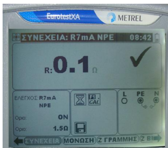
Σχήμα 5.9. Μέτρηση συνέχειας R7mA
