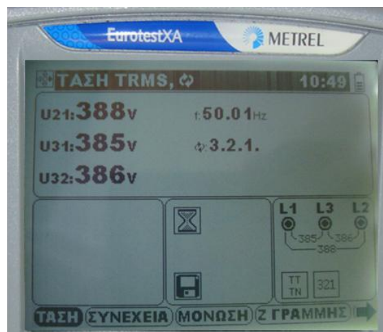
Σχήμα 5.4. Παράδειγμα τριφασικής μέτρησης και διαδοχή φάσης
