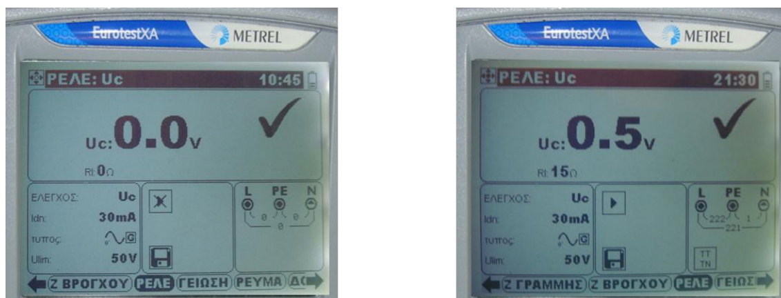
Σχήμα 5.27 Παράδειγμα μέτρησης τάσης επαφής
