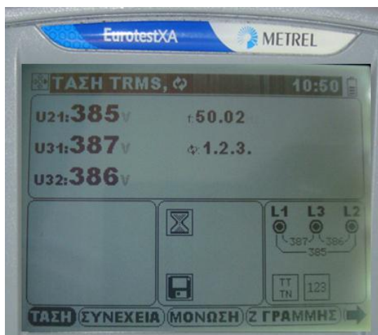
Σχήμα 5.4. Παράδειγμα τριφασικής μέτρησης και διαδοχή φάσης
